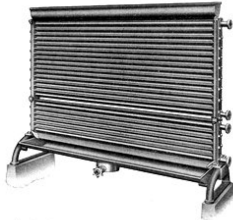
Fig. 70. Koeler van Schmidt bestaande uit twee afzonderlijke gedeelten, het bovenste voor koeling met notonwater, het onderste voor koeling met pek.
