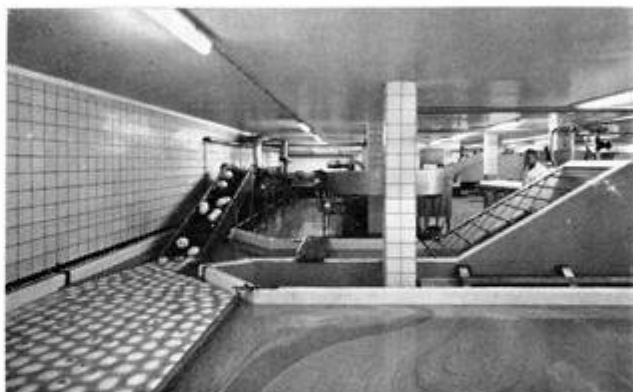
12. „Pekelsloot” met spoel-, droog- en plastificeer- banen (edammer-lijn).
