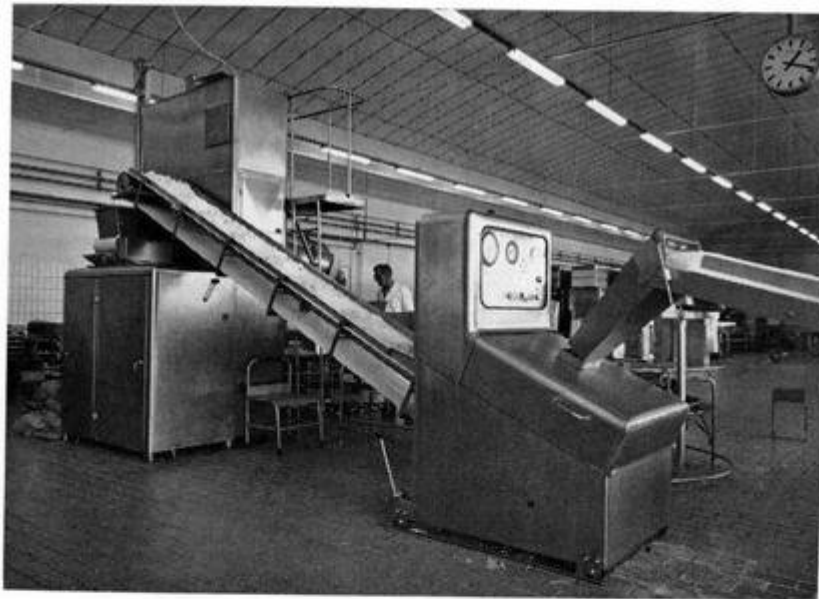
7. De Bell-Siro wrongelsnijmachine en zoutdoseringsinstallatie.
