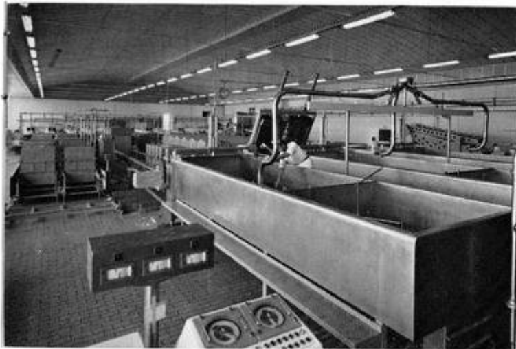
5. Overzicht kaasafdeling (draineerbakken, cheddarboxen en persen).
