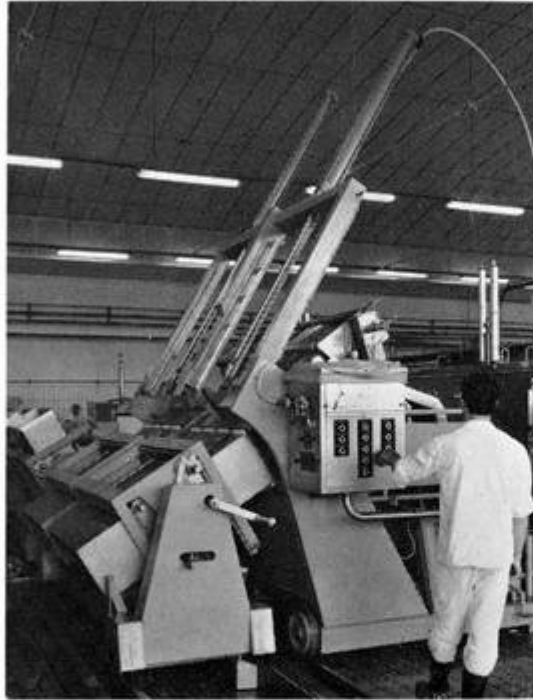
6. Het boxenvulapparaat (cheddar-lijn).
