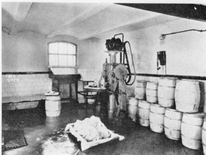
Boterkelder met botervormmachine voor pakjes van 250 en 500 gram en botervaten voor 25 en 50 kg boter
